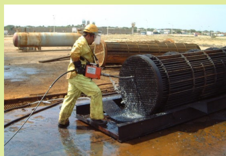
Figure n°2 : utilisation de la lance en mode manuel par l'opérateur
