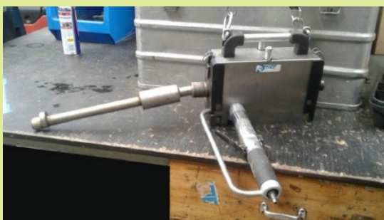
Figure n°1 : lance avec entrainement pneumatique du flexible
