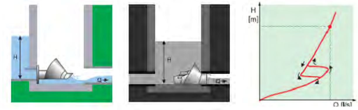
Figure 128 : Régulateurs à effet vortex (Techneau)
