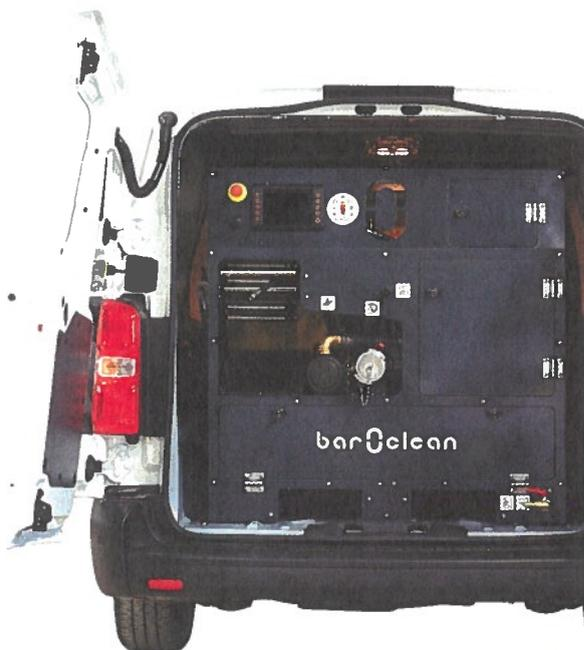
Chez Baroclean, la gamme d'hydrocureurs de première intervention thermique, est complétée par deux modèles électriques. Décliné de l'hydrocureur thermique Skid, le E-Skid est un groupe haute pression polyvalent. Reprenant les caractéristiques de son aîné, il est équipé d'un réservoir de 400 à 600 l, de deux enrouleurs (HP, BP) manuel, d'une pompe 3 pistons céramiques plein, assurant un débit de 40 l/m. pour une pression de 150 bars.
