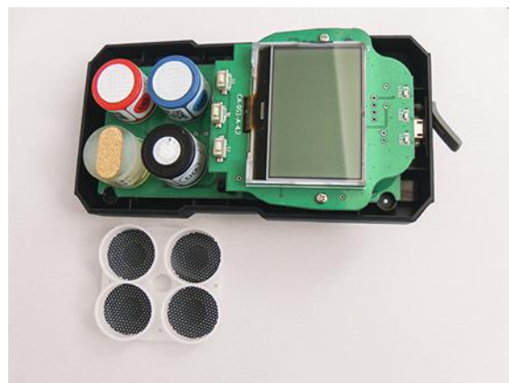
↑ FIGURE 14 Configuration où les capteurs sont positionnés directement au niveau de la carte principale. Les capteurs bleu (H 2 S), rouge (CO) et noir (O 2 ) sont facilement retirables, le capteur catalytique (ovale doré) est soudé sur la carte. À noter que l'accès à la batterie est difficile, car il nécessite de démonter la carte supportant l'écran d'affichage.
