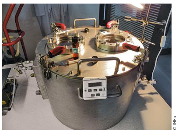
↑ FIGURE 8 Enceinte de génération de 42,5 dm 3 utilisée pour les essais d'expositions au dihydrogène et à l'éthanol. Le volume d'essai est étanche. Des hublots permettent de visualiser les appareils posés sur le fond de la cuve. Un ventilateur de brassage assure l'homogénéisation de l'atmosphère. Deux septa permettent d'introduire via des seringues soit un composé gazeux (hydrogène H 2 ), soit un composé liquide (éthanol CH 3 -CH 2 -OH), qui va s'évaporer.
