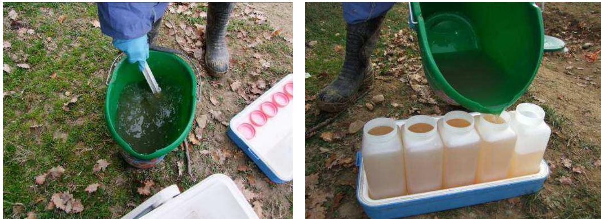
Figure 2 : échantillons élémentaires pour reconstituer un échantillon moyen, puis mise en flacons
