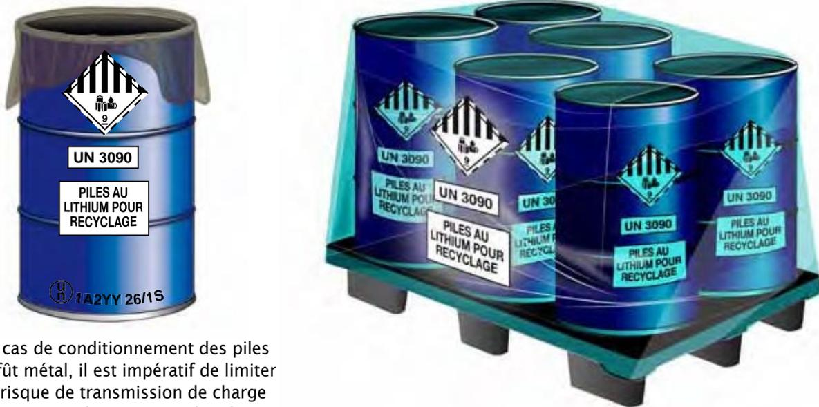
En cas de conditionnement des piles en fût métall, il est impératif de limiter le risque de transmission de charge électrique en utilisant une sache plastique
