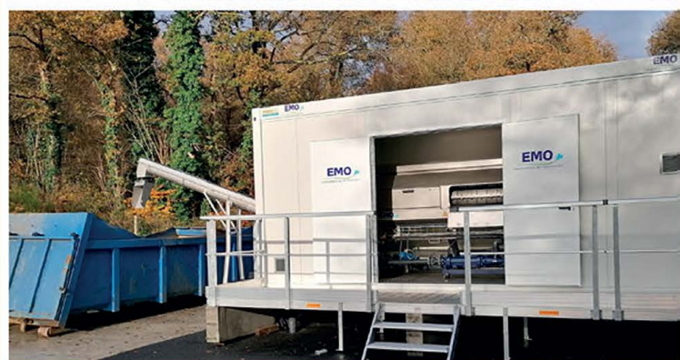
Unité de déshydratation de boues en abri modulaire PRESSE A VIS
