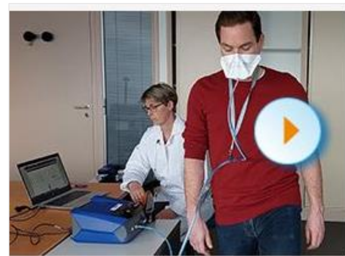
Essai d'ajustement sur appareil de protection respiratoire (Anim-372)
